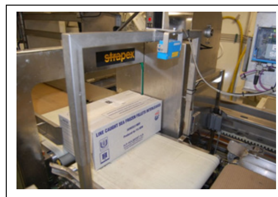
Bilde 6 Stripsing og registrering
